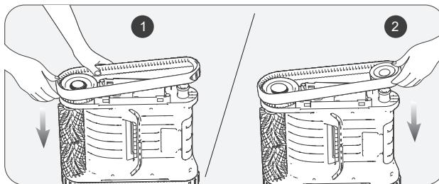
ε. Τοποθετήστε ξανά τα λευκά καλύμματα οδηγούς ευθυγραμμίζοντας τα ανοίγματα σχήματος D με εκείνα των καλυμμάτων του άξονα.
