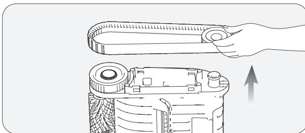
δ. Ευθυγραμμίστε τους οδοντοτροχούς των καινούριων ερπυστριών με τους οδοντοτροχούς και των δύο τροχών και, στη συνέχεια, τοποθετήστε μαζί τους πίσω τροχούς και τις ερπύστριες ξανά στα καλύμματα του άξονα.
